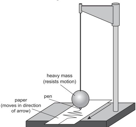
Figure 1. Seismometer
